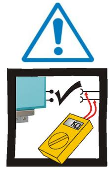
Débranchez l'appareil des circuits lorsque vous procédez à des contrôles d'isolation à tension élevée.
