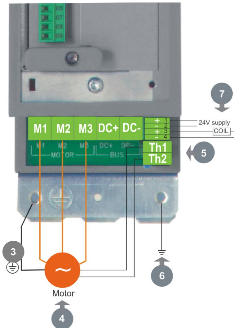
4 Raccordez les câbles moteurs aux bornes M1, M2 et M3. Tailles de câble max. :
