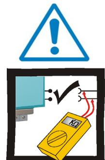
Débranchez l'appareil des circuits lorsque vous procédez à des contrôles d'isolation à tension élevée.
