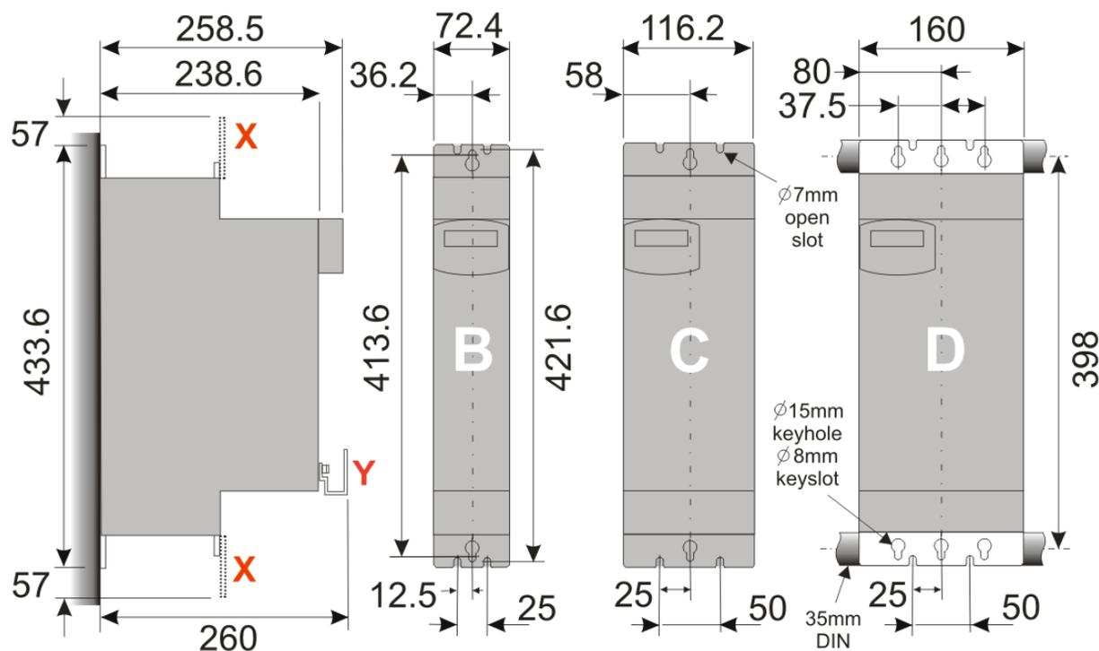
Les dimensions sont en millimètres (X : Support d'alimentation – Kit d'installation du 890, Y : Support de commande)
